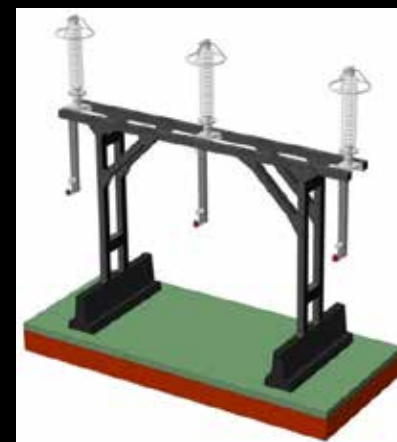
Блок 110кВ ОПН.
