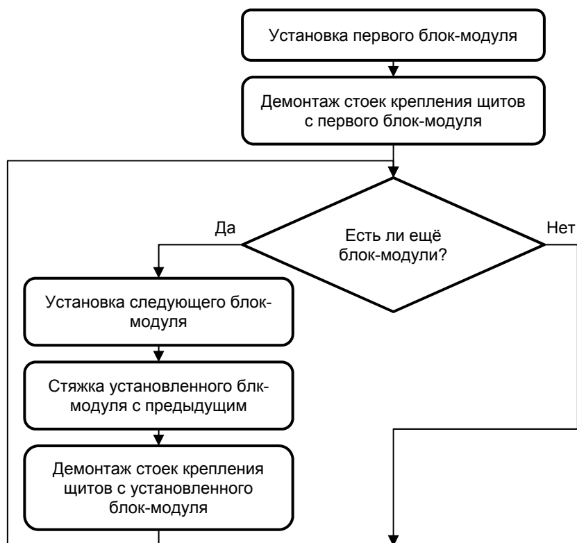
Рисунок 5 – Блок-схема процесса установки и стыковки блок-модулей
